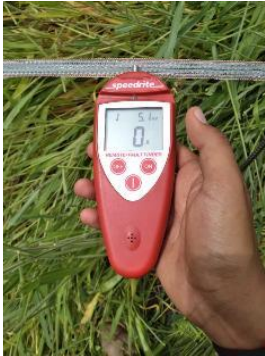
ILUSTRACIÓN 23. MULTÍMETRO PARA CHECAR EL VOLTAJE DEL CERCO ELÉCTRICO
